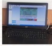
Дистанционное управление с ПК. Специальный программный комплекс позволяет дистанционно управлять процессами в одной или нескольких сушильных камерах, проводить диагностику, корректировать режимы сушки, распечатывать графики и соответствующую информацию. Наши разработчики предусмотрели и возможность получения клиентом через Интернет всех необходимых технологических консультаций.
