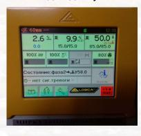
Контроллер dTouch имеет цветной дисплей touchscreen, интуитивно понятный интерфейс, 400 предустановленных программ сушки для различных пород и 20 мест для программ пользователя. Число фаз в цикле сушке — до 30. Датчики: по 2 датчика температуры и влажности среды и 8 или 12 датчиков влажности древесины.
