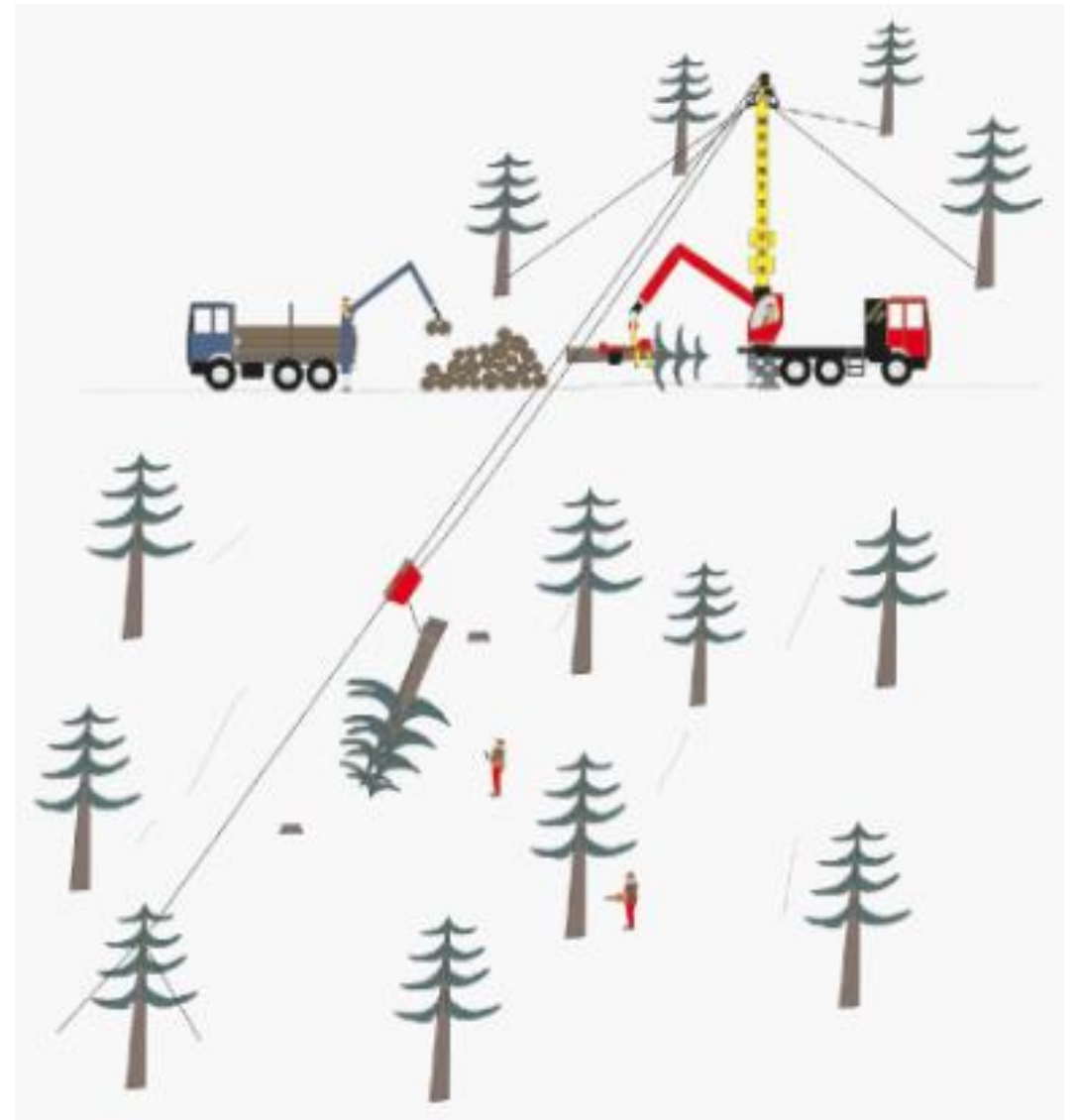
Схема работы горного процессора компании Konrad Forsttechnik GmbH
