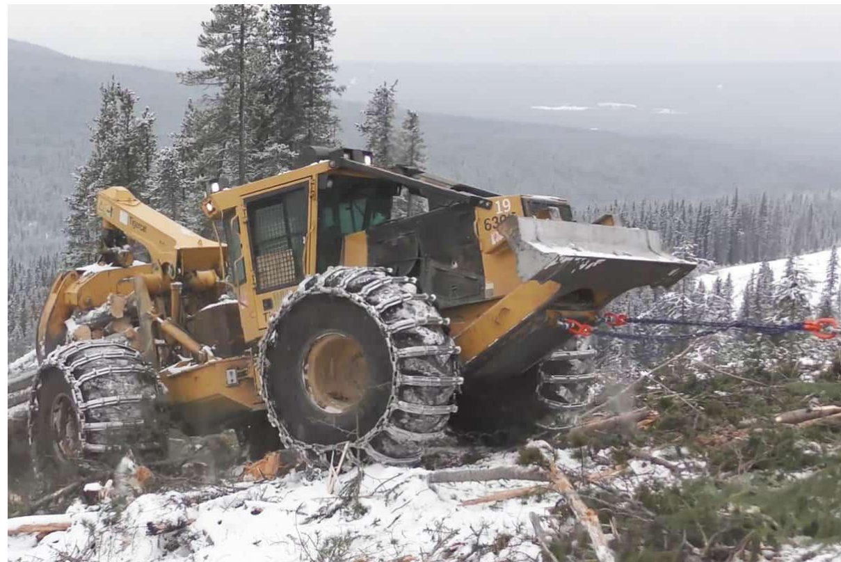
Работа скиддера на горном склоне в сцепке с самоходной лебедкой
