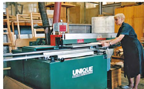
Станок для обработки фасадов из массива
