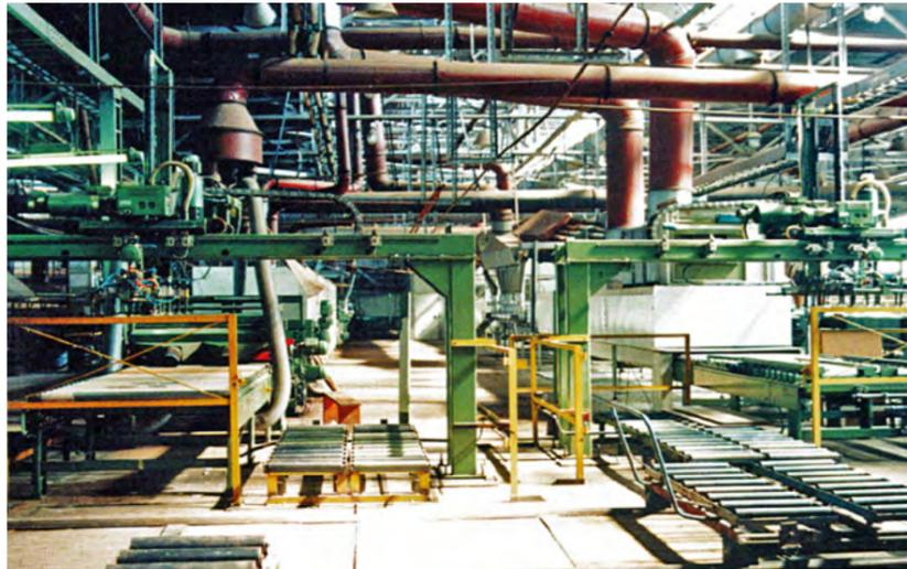
В производстве мебели применялись многопозиционные линии по обработке древесно-стружечных плит
