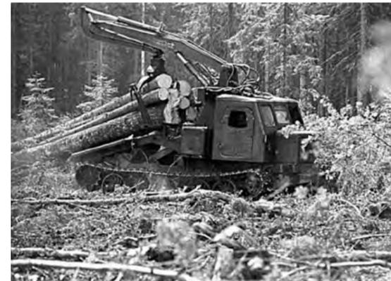
Трактор с гидроманипулятором ЛП-18
