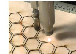
Рис. 3. Процесс лазерной резки фанеры [3]
