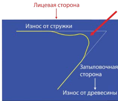
Рисунок 1. Схема износа фуговального ножа
