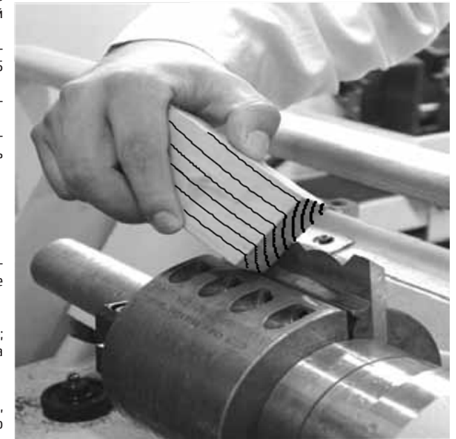
Рисунок 8. Снятие заусениц бруском из твердой древесины
