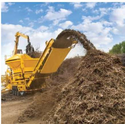
Увеличенные подающие столы, приемные камеры большего размера и увеличенные ленты выгрузного конвейера конечного продукта позволяют данным агрегатам справляться с поистине колоссальными объемами
