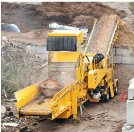
Оборудование измельчает древесину (горбыль, баланс) порубочные остатки, выкорчеванные пни с землей и другие древесные материалы в топливную или технологическую щепу требуемой фракции.
