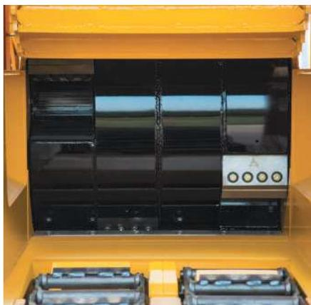
Компактная но мощная машина позволит производить щепу даже на самых удаленных участках лесозаготовки. Модель на гусеничном ходу обладает большей проходимостью. Ножевой барабан и контранож уникальной конструкции позволяет регулировать размер конечной фракции щепы.
