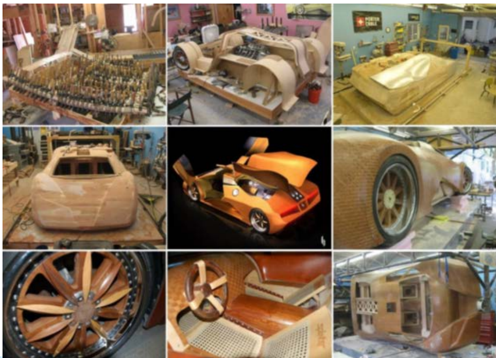
Рис. 7. Этапы работы по созданию суперкара Splinter
