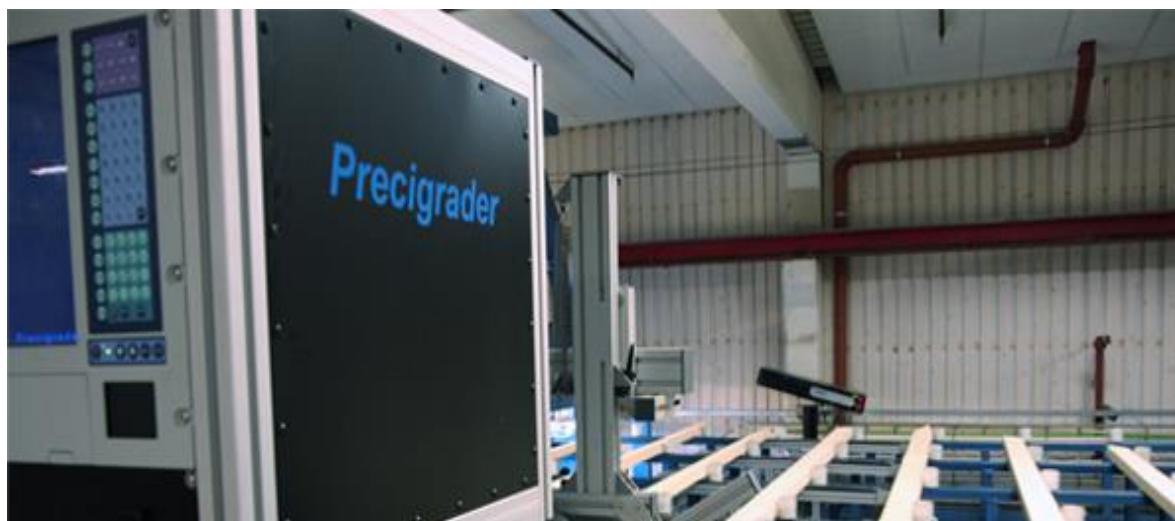
Рис. 14. Установка по оценке прочности древесины по скорости прохождения ультразвука
