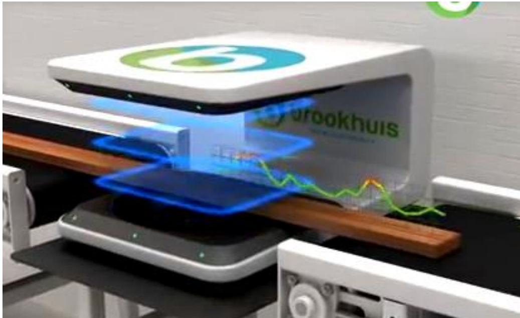
Рис. 17. Бесконтактная оценка влажности пиломатериалов на оборудовании Brookhuis Micro-Electronics
