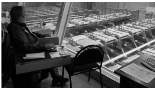
Рис. 11. Оценка поверхности пиломатериалов а – визуальная оценка, б – лазерное и фотометрическое сканирование
