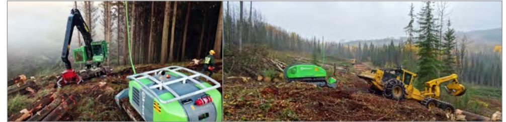
с четырьмя точками фиксации. Большое преимущество на машинах Komatsu дает функция Crane tilt, которая позволяет мотору вращать гидроманипулятор наклонным углом от 5° до 15° (22° в стояночном положении). Это дает существенное преимущество при работе на крутых склонах, так как поворотный мотор гидроманипулятора получает значительно большую мощность. Эта функция наклона встроена в поворотный корпус, что позволяет сократить общую высоту конструкции.
