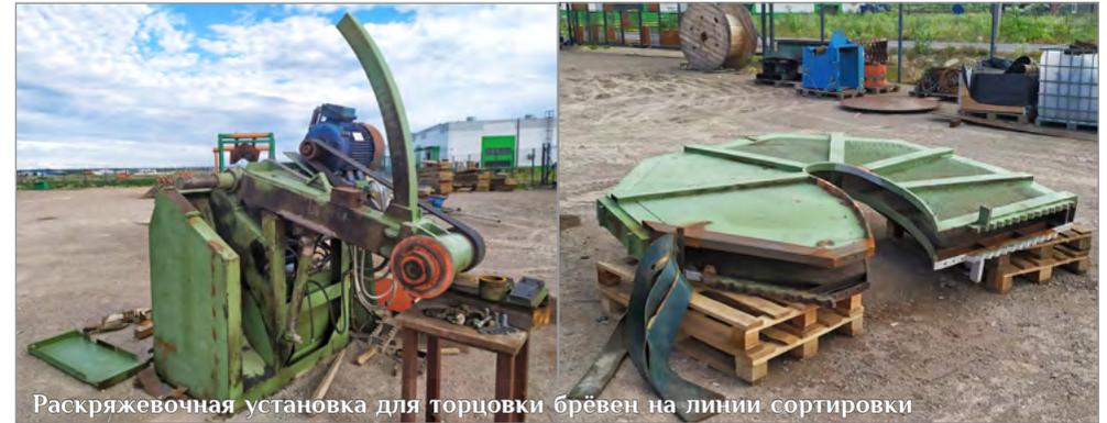
Раскряжевочная установка для торцовки брёвен на линии сортировки
