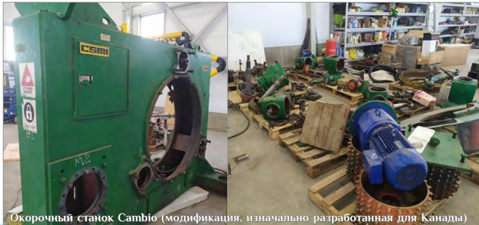
Окорочный станок Cambio (модификация, изначально разработанная для Канады)
