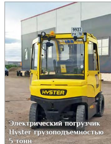
Электрический погрузчик Hyster грузоподъемностью 5 тонн
