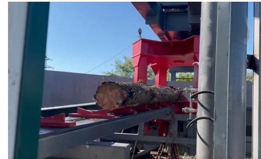
Линия сортировки круглых лесоматериалов Krafter, изготовленная компанией «Ками», включает 20 карманов для бревен, разворотное устройство, и оснащена электромеханическими сбрасывателями.
