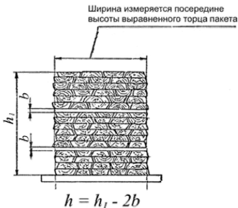
Ширину пакета следует определять путем измерения со стороны выравненного торца посередине высоты его между двумя условно проведенными вертикальными линиями, ограничивающими боковые стороны пакета (рис. 1).
