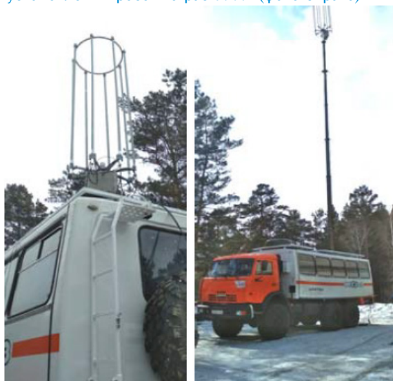
Рисунок 7. Антенна АПКУ в нижнем положении мачты, видна площадка доступа и лестница (фото слева), АПКУ в развернутом положении, установлены тросовые растяжки (фото справа)
