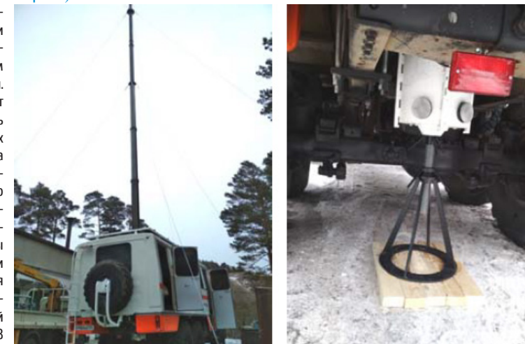
Рисунок 6. Телескопическая мачта АПКУ (фото слева) и винтовой упор блокирования работы подвески автомобиля-базы (фото справа)
