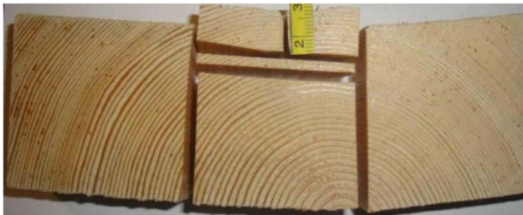
Рисунок 6. Глубина распространения микротрещины в лиственничной доске при сушке в свободном состоянии
