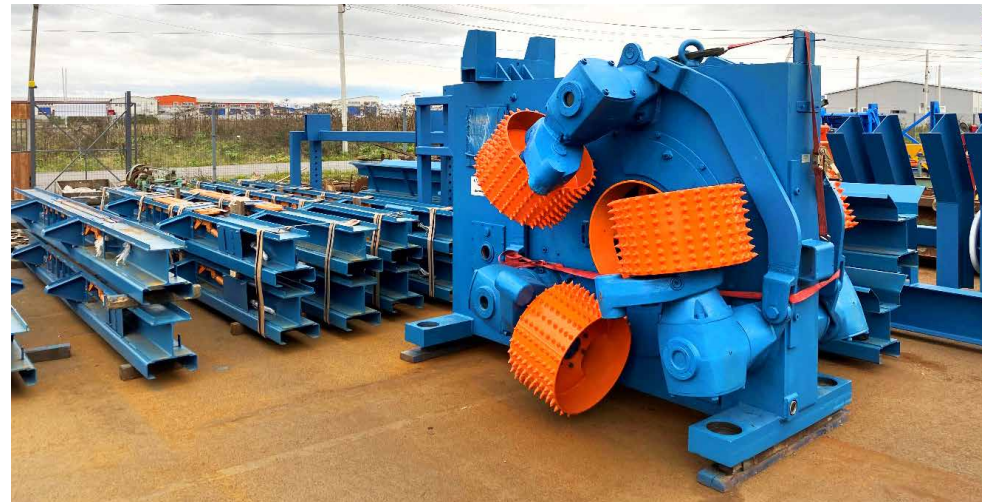
Восстановленный окорочный станок Cambio 75
