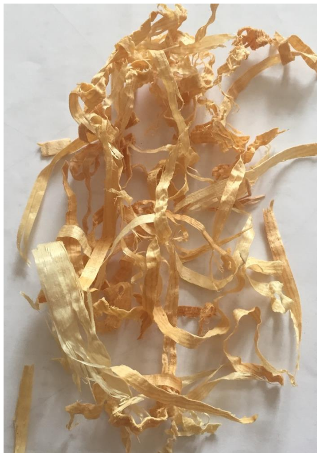
Фото «сливной стружки» при пилении на двухвальных станках
