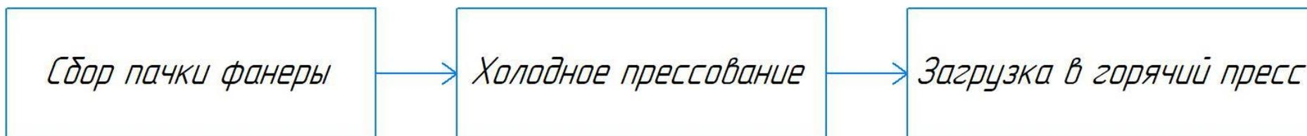
Рисунок. 7. Технология производства фанеры с добавлением карбамида
