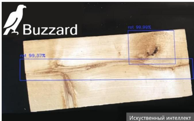
**Buzzard.** Распознавание гнили – это весьма сложная задача для любых сканирующих систем, так как гниль имеет немного характерных визуальных свойств. Для эффективного решения этой задачи используется модуль искусственного интеллекта Buzzard, работающий на основе нейронных сетей, который не требует специальных знаний при настройке и значительно снижает вероятность ошибок.
