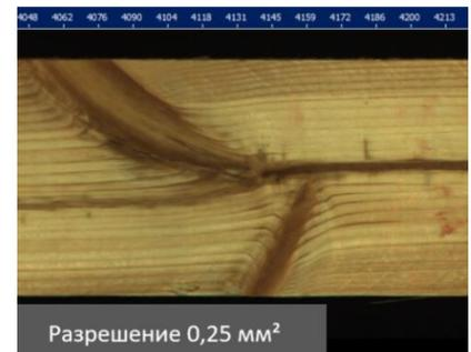
**X-Ray.** Функции X-Ray и Knot-Linking позволяют отслеживать расположение сердцевины и сучков в пространстве доски, что позволяет правильно определять расположение доски в бревне и распознавать отверстия от сучков. Также эта информация используется в программе силовой сортировки.
