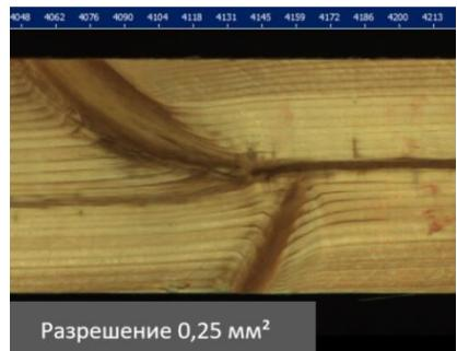
**X-Ray.** Функции X-Ray и Knot-Linking позволяют отслеживать расположение сердцевины и сучков в пространстве доски, что позволяет правильно определять расположение доски в бревне и распознавать отверстия от сучков. Также эта информация используется в программе силовой сортировки.
