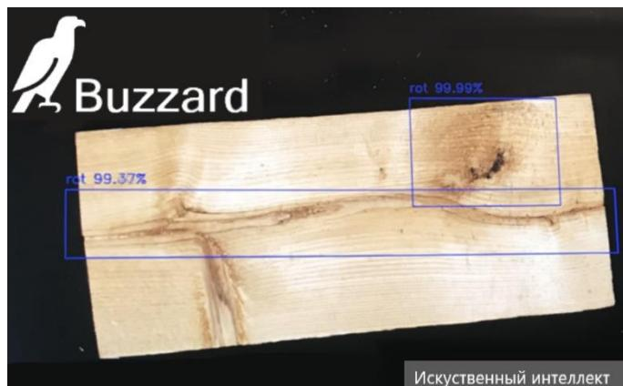
**Buzzard.** Распознавание гнили – это весьма сложная задача для любых сканирующих систем, так как гниль имеет немного характерных визуальных свойств. Для эффективного решения этой задачи используется модуль искусственного интеллекта Buzzard, работающий на основе нейронных сетей, который не требует специальных знаний при настройке и значительно снижает вероятность ошибок.
