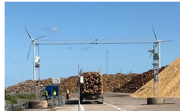
Рисунок 7. Современная бесконтактная измерительная рамка
