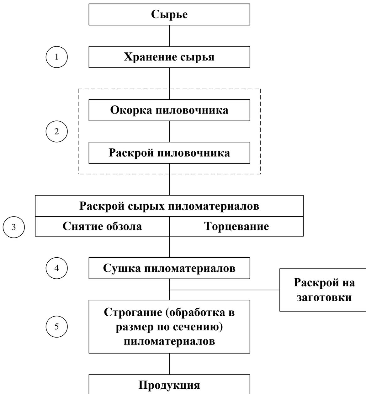
**Рис. 4** Структура технологического процесса производства сухих строганых пиломатериалов из цельной древесины
