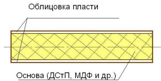
Рис. 2.4. Симметричное облицовывание плит ДСтП
