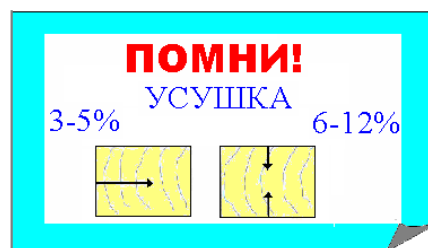
Рис. 6.1. Деформации заготовок в зависимости от месторасположения по сечению пиловочника
