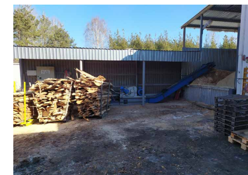
Измельчение кусковых отходов древесины перед сжиганием
