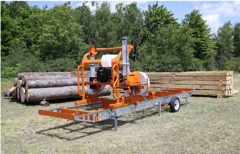
Мобильный лесопильный станок (ленточнопильный, горизонтальный)
