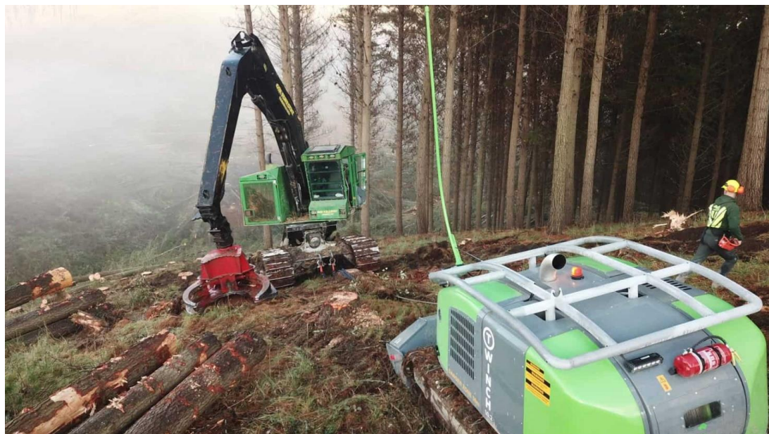
Валочно-пакетирующая машина с лебедкой T-Winch
