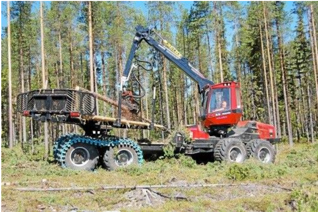
Харвардер (валочно-сучкорезно-раскряжевно-трелевочная машина), производства компании Комацу
