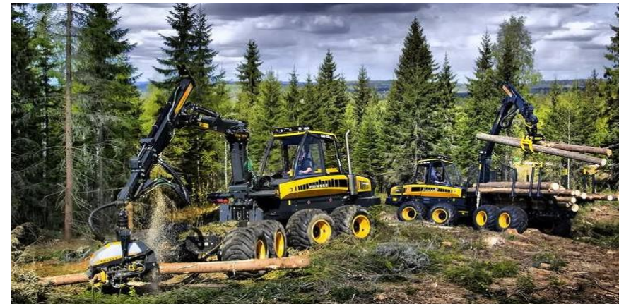
Система машин при вывозке сортиментов – харвестер и форвардер
