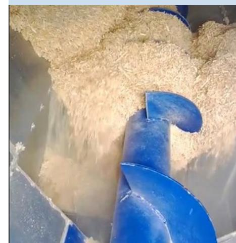
В зависимости от устройства лоткового шнека фильтры MultiStar со шнековой выгрузкой подходят для особенно тяжелых и плотных материалов.
