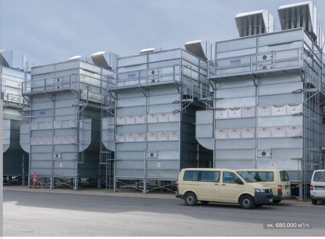
Фильтр MultiStar с ворошителем с импульсной регенерацией • производство кухонной мебели
