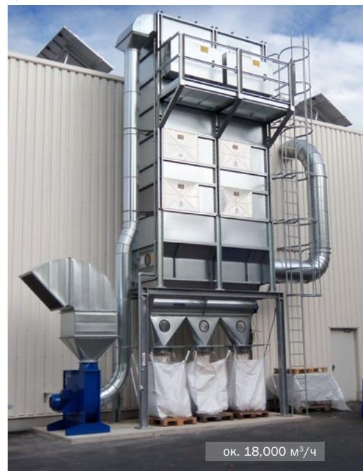
Фильтр MultiStar с импульсной регенерацией в производстве сборных домов
