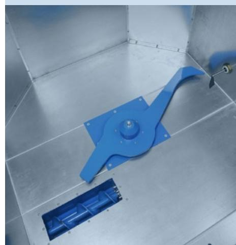
Установки MultiStar с интегрированными прессами собирают отходы и прессуют их непосредственно в брикеты. Они являются идеальным решением для работы с низкими и средними объемами материала.
