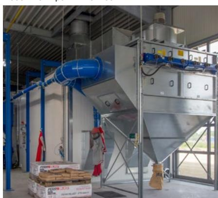
Карtridgeный фильтр с импульсной регенерацией
