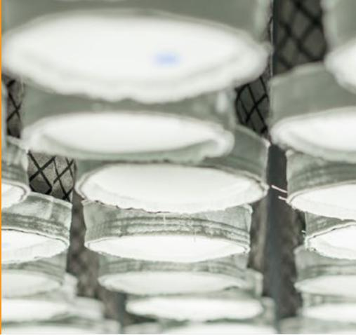
Загрязненный пыльный воздух проходит через фильтровые рукава. При постепенном оседании пыли на фильтровой материал происходит потеря производительности по воздуху. Поэтому при определенном уровне потери давления фильтровые рукава должны постоянно и регулярно регенерироваться для того, чтобы эффективность всасывания оставалась неизменной.
