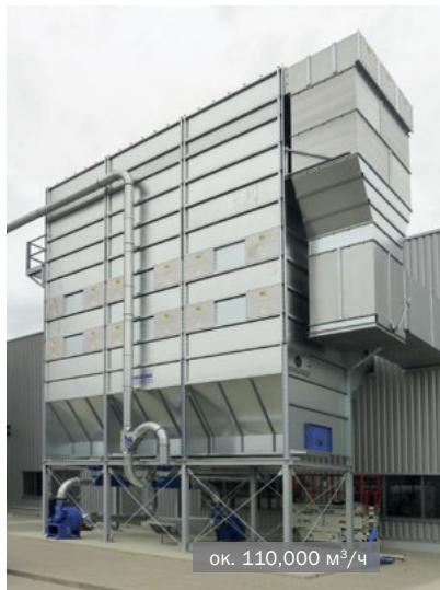
Фильтр MultiStar со шнеком, с продувочным воздухом Гибкая выгрузка в транспорт с двумя выходами
