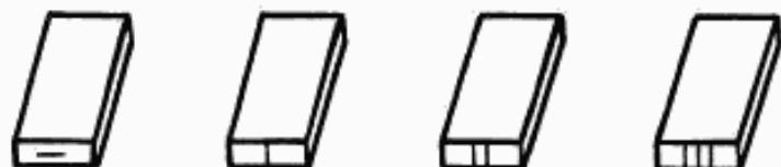
**МАРКИРОВКА ПИЛОМАТЕРИАЛОВ (ВКЛЮЧАЯ БРУСЬЯ) И ЗАГОТОВОК МЕЛКОМ НА ПЛАСТИ**
