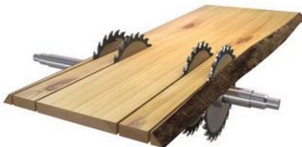
Рис. 42 Принципиальная схема работы обрезного станка
