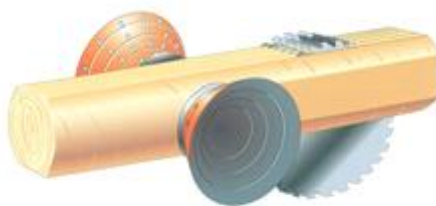
Рис. 35 Схематичное изображение работы фрезерно-пильного оборудования
