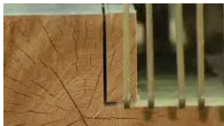
Рис. 31 Принцип распиловки методом «углового пиления»
