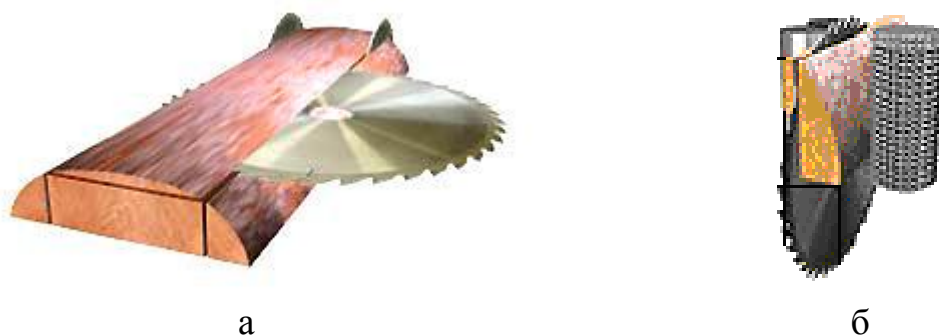
Рис. 41 Схема работы реброво-горбыльного станка а – горизонтального, б – вертикального
