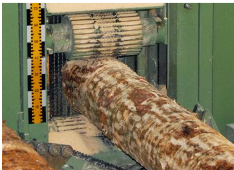
Рис. 23 Схема подачи бревен в лесопильную раму
