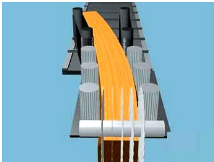
Рис. 40 Схема криволинейной распиловки бруса
