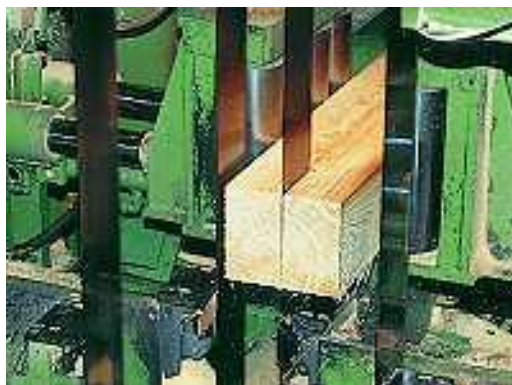
Рис. 27 Пример распиловки двухкантного бруса на втором проходе при помощи счетверенных ленточнопильных станков
