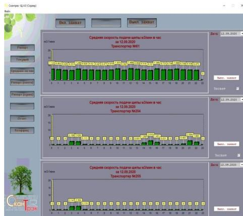
1) Суточный рапорт подачи щепы подаваемый в плотных (обновление каждые 10 сек.) (рис.№1)
