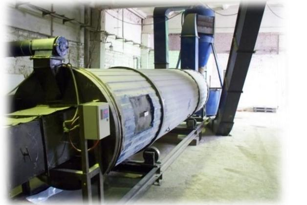
В 2008 для компании «ПечораЭнергоРесурс» (республика Коми) было изготовлено и сдано в эксплуатацию оборудование для линии гранулирования древесных отходов производительностью 2,5 т/час по готовой продукции (оборудование участка суши с циклонными установками, газоходами, охладителем гранул, оперативным бункером сухого материала для пресса-гранулятора, бункером готовой продукции и т.д.);
