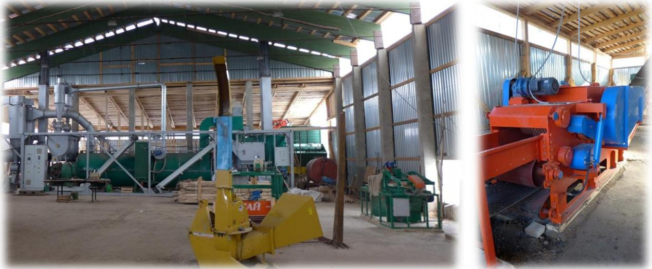
Также в 2017 г. для компании «Паллет строй» из Липецка был изготовлен и сдан в эксплуатацию сушильный комплекс для сушки древесного опила на основе роторной барабанной сушилки РБС 16/55 производительностью 1000 кг/час по готовой продукции.
