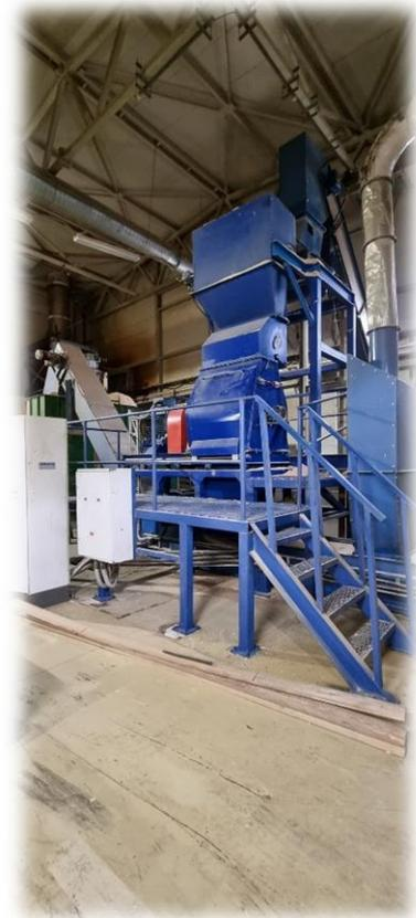
В 2023 г. для компании «ПаллетГрупп» (г. Воронеж) было изготовлено и поставлено оборудование сушильного комплекса (бункер с подвижным полом, транспортёры, дробилка сырой щепы, сушилка РБС, циклонная установка, щит управления).
