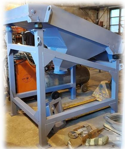
В 2022 г. для компании «Череповецлес» на основе разработанных ранее молотковых дробилок серии МД была спроектирована и изготовлена молотковая дробилка МД9х10 для измельчения сухой щепы производительностью до 5 тонн/час.
