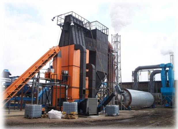
В 2009-2010 г. для компании «СК «Русь» (п.г.т. Сосново, Ленинградская область) была поставлена, смонтирована и запущена в эксплуатацию линия гранулирования сухих отходов на основе пресс-системы SPC PelletPress 450 Компакт производительностью 450 кг/час по готовой продукции. Для дооснащения линии был изготовлен бункер сырья и система пневмотранспорта для загрузки бункера сырьем, а также линия фасовки;
