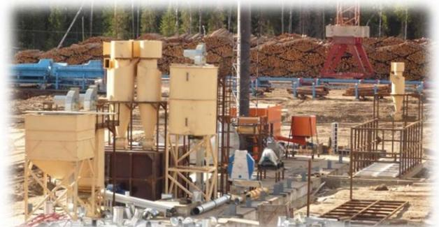
В 2010 г. для компании «Пеллет-Энерго Украина» (г. Житомир) был разработан, изготовлен и сдан в эксплуатацию сушильный комплекс производительностью 8 т/час по сухому материалу для сушки микрощепы;
