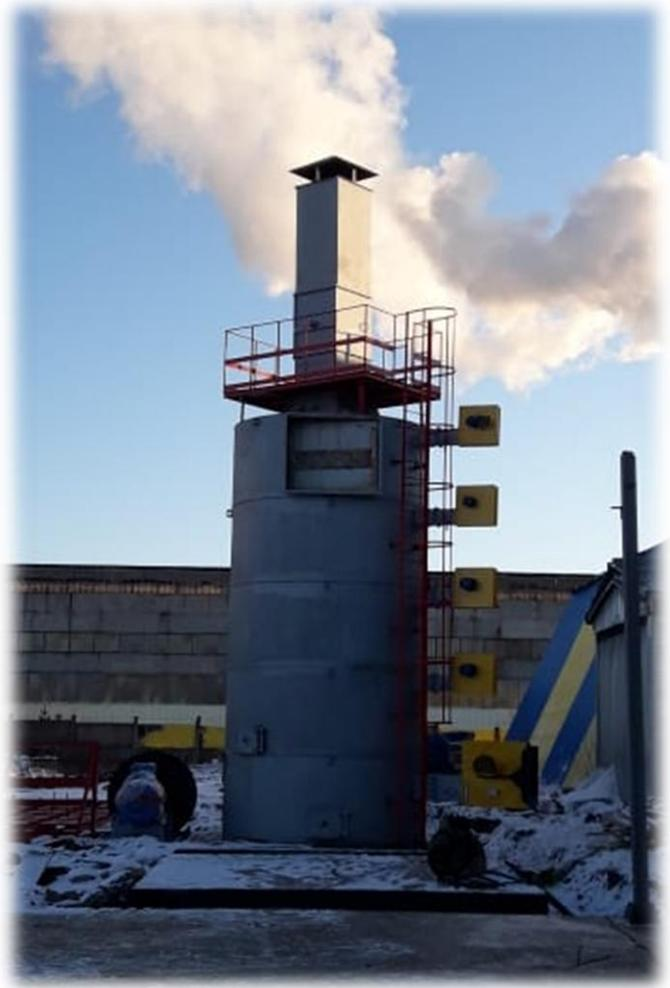
В 2021 г. для компании по заказу компании из Белоруссии были изготовлено и поставлено оборудования для линии гранулирования (охладитель гранул производительностью 3 тонны/час, оперативный бункер сырья для пресса-гранулятора Munch RMP650, циклонная установка).
