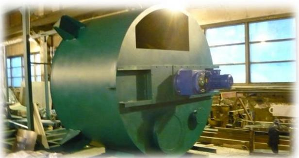
В 2013-2014 г. была разработана и изготовлена модульная (мобильная) линия по производству древесных топливных гранул производительностью по готовой продукции 800 кг/час из опила естественной влажности. Модульная линия установлена и эксплуатируется на Подборовском деревообрабатывающем комбинате (п. Подборовье Ленинградской области). В линии применена пеллетная горелка.
