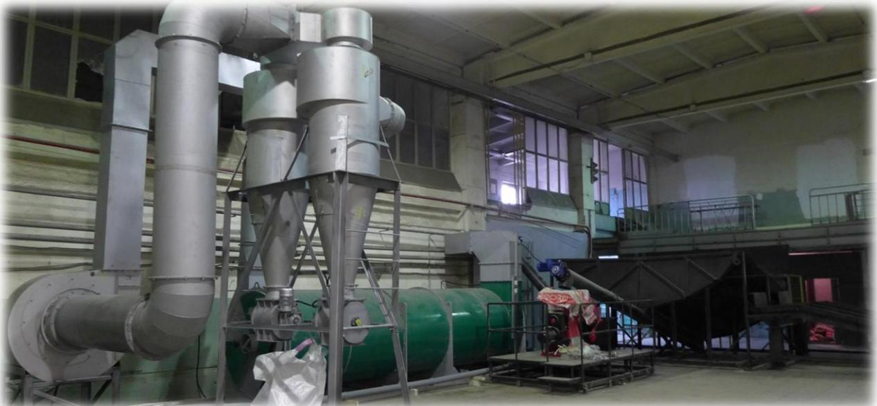
В 2017 г. по заказу ИП из Ярославской области была изготовлена модульная (мобильная) линия по производству древесных топливных гранул производительностью по готовой продукции 1000 кг/час из горбыля и балансов естественной влажности. В качестве источника тепловой энергии для сушилки была применена пеллетная горелка.
