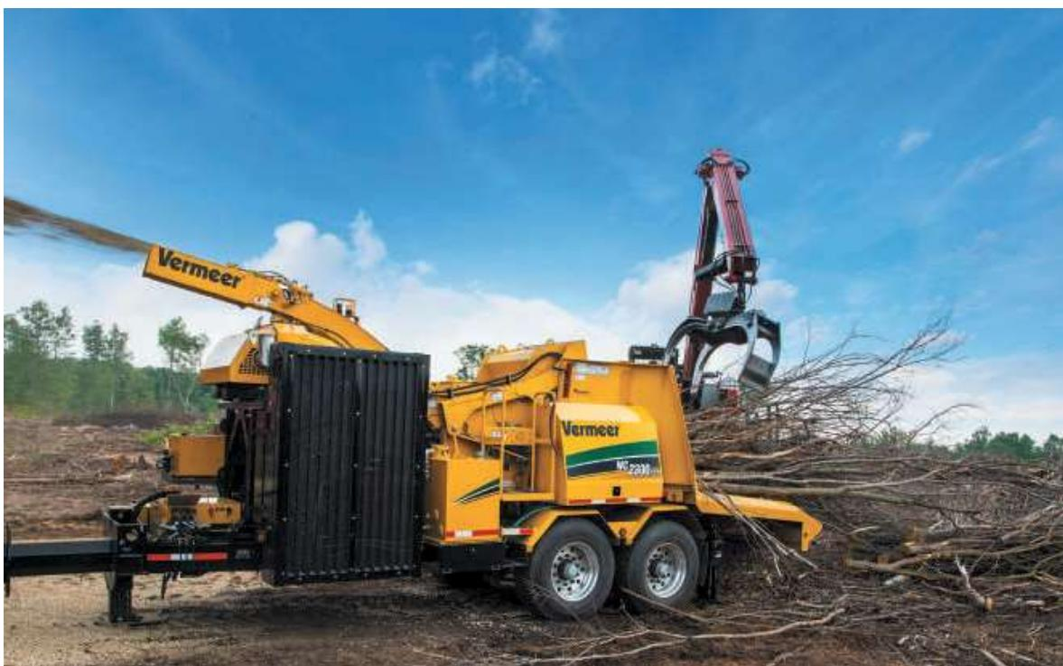
1 Система SmartCrush - может автоматически увеличивать давление прижима при попадании на режущий барабан сложного материала и регулировать скорость движения сдвоенного цепного стола
