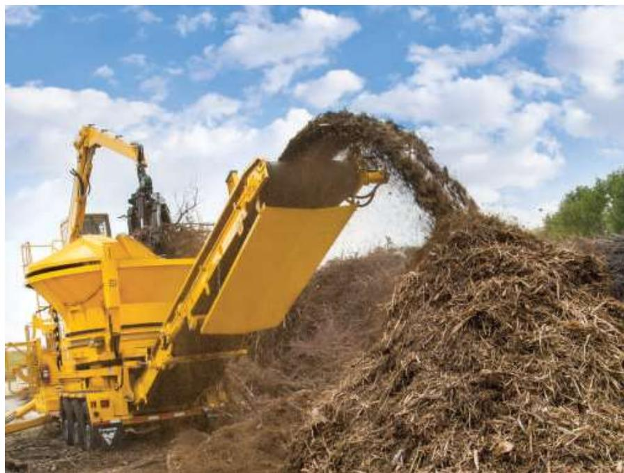
Увеличенные подающие столы, приемные камеры большего размера и увеличенные ленты выгрузного конвейера конечного продукта позволяют данным агрегатам справляться с поистине колоссальными объемами
