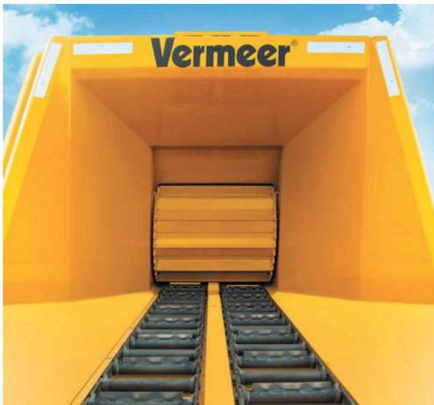
Благодаря некоторым вариантам выбора ножей один измельчитель может производить древесную щепу разного размера в соответствии с требованиями конечного пользователя. Для перемещения измельчителя целых стволов по рабочему участку используется трелевочный механизм с захватом. Барабан и разгрузочный желоб оснащены, закрепленными болтами, заменяемыми изнашиваемыми деталями, что увеличивает срок службы машины и облегчает проведение ее технического обслуживания.
