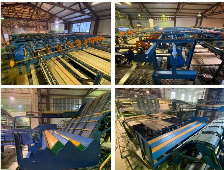
Установка нового оборудования выполняется в рамках модернизации участка сортировки пиломатериалов. Целью реконструкции является увеличение производительности комбинированной линии сортировки сырых и сухих пиломатериалов в два раза.
