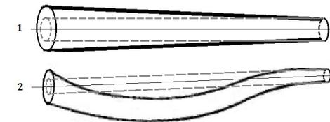
Как и габаритную кривизну, характеризующую габаритным цилиндром, к порокам, не указанным в ГОСТ 2140, можно отнести двойную вершину. Двойная вершина возникает как порок в результате механической обработки при поперечном пропиливание ствола дерева выше развилки. При правильном распиле, выполненном непосредственно под развилкой, на торце сортимента наблюдается двойная сердце-
