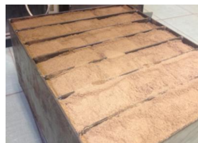
Рис. 1. Экспериментальная установка для термического модифицирования измельчённой древесины в плотном слое
