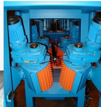
Вальцовый кантователь – точность 10 градусов (2 минуты на стрелке часов)
