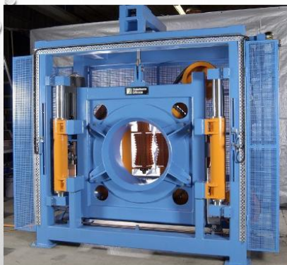
Роторный кантователь – точность 5 градусов (1 минута на стрелке часов)
