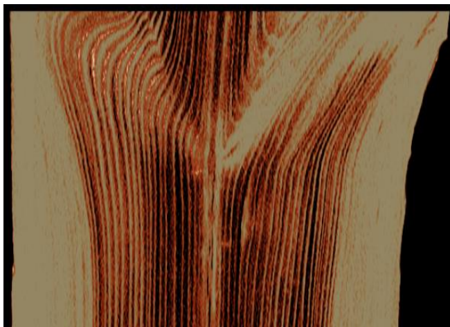
Рис. 10. Продольный разрез древесины сосны полученный методом КТ (определение текстуры древесины при строгании шпона)
