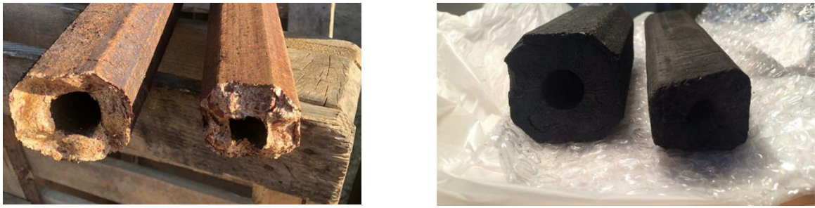
Рисунок 2 – Древесные и древесно-угольные брикеты, разработанные автором
