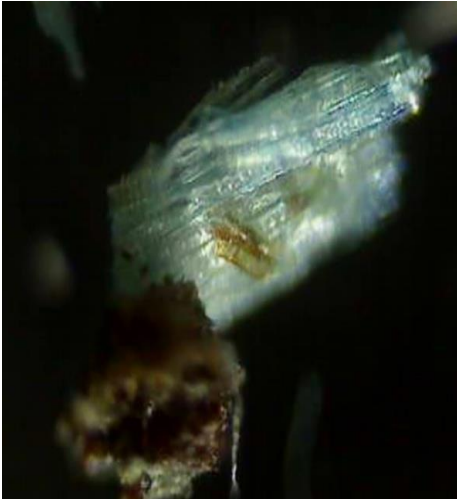
Рисунок 6 – Свежие (А) и старые (Б) опилки лиственницы, окрашенные голубым красителем (x90)
