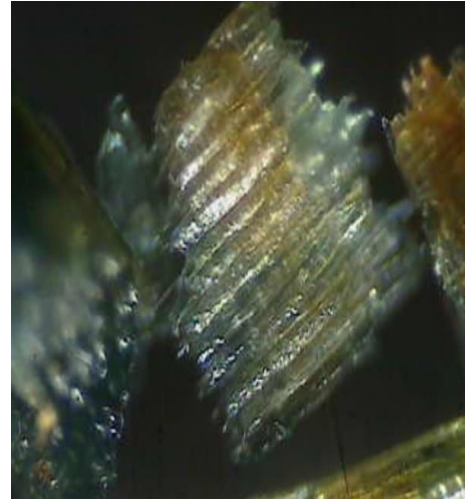
Рисунок 6 – Свежие (А) и старые (Б) опилки лиственницы, окрашенные голубым красителем (x90)
