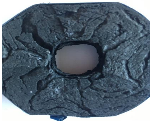
Рисунок 27 – Фотография поперечного среза карбонизированного брикета
