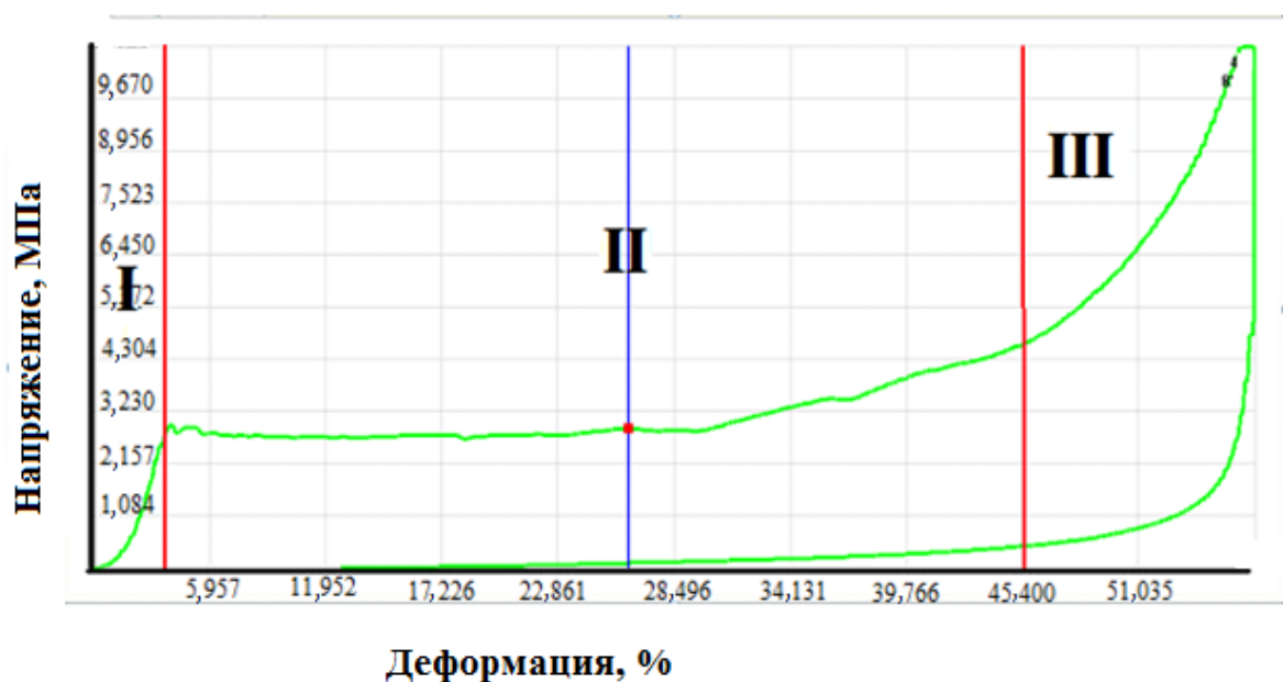
Рисунок 12 – Диаграмма сжатия – разгрузки образца древесины лиственницы (при P=4500 \text{ Н} )
