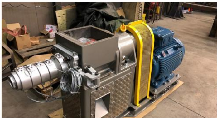
Рисунок 23 – Экструдер для получения древесных брикетов
