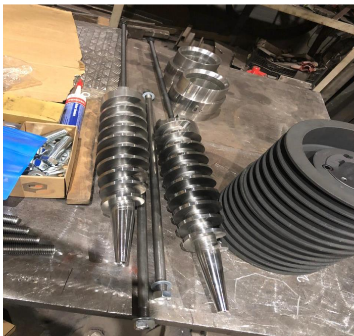
Рисунок 22 – Шнеки и фильеры, используемые при получении древесных брикетов
