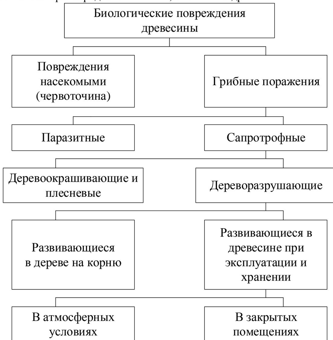
Рис. 3.8. Классификация биологических повреждений древесины /16/
