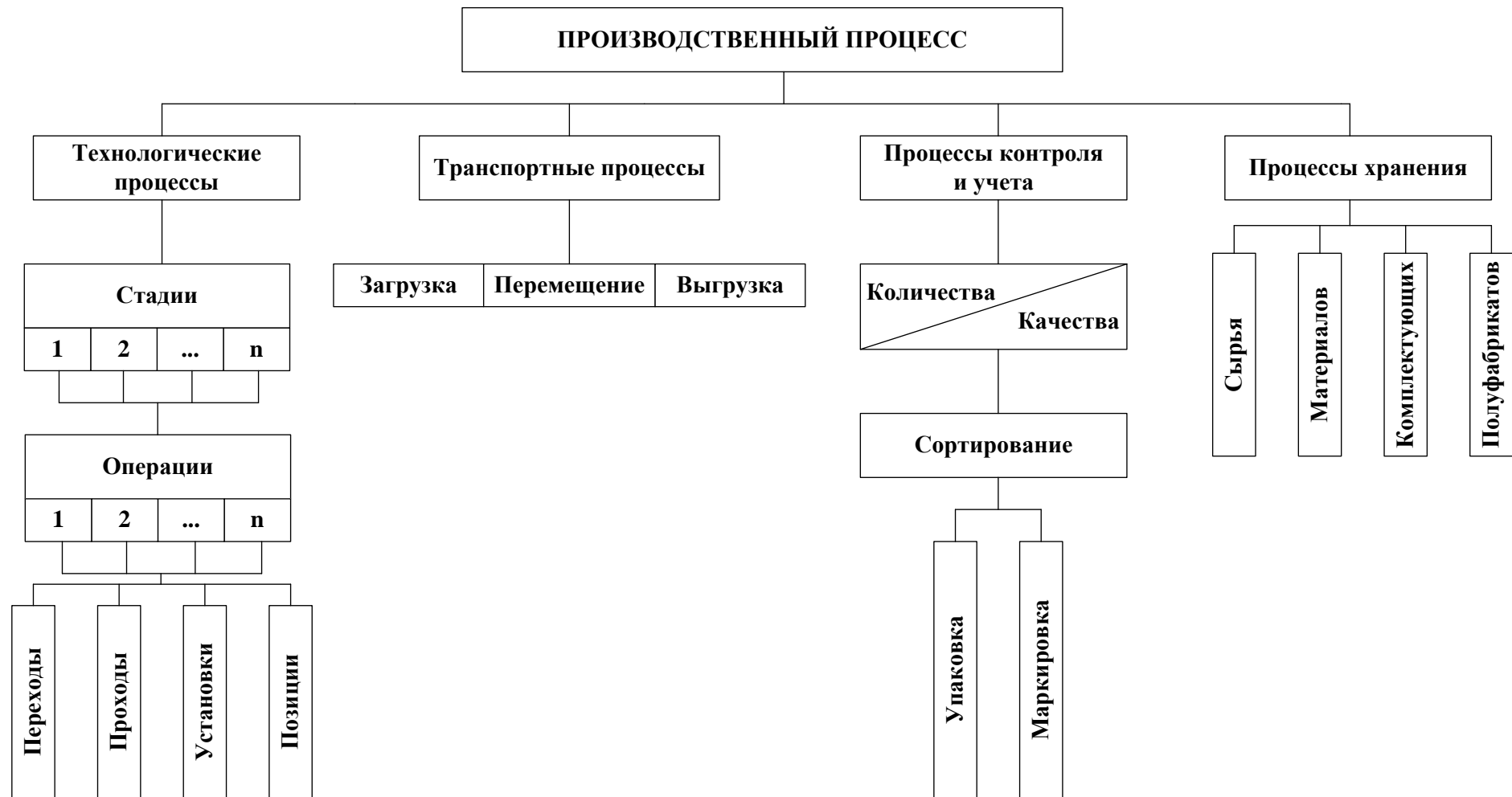
Рис. 3.6 Структура производственного процесса
