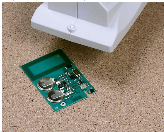
Датчик Easylog+ для непрерывного измерения параметров давления газа и температуры внутри ковра из древесных материалов
