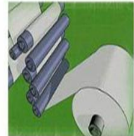
Бумагоделательная машина. Одни валики отжимают воду, другие, высушивают бумагу, третьи полируют и наматывают в огромный рулон.
