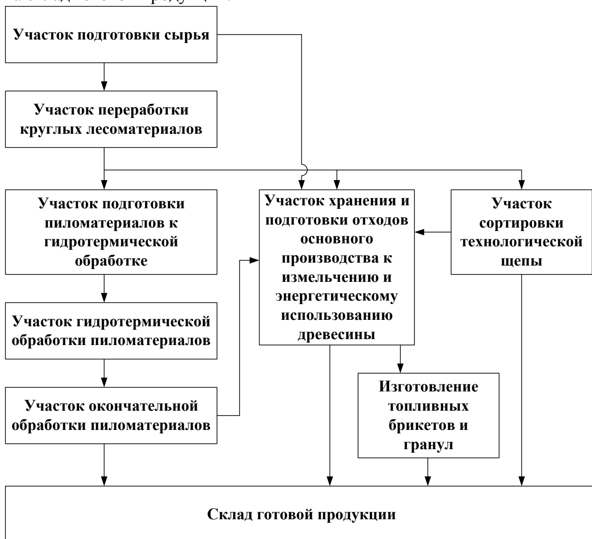
Рис. 5. Структура лесопильного производства
