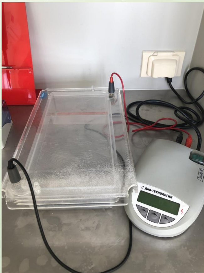
Рисунок 4 –а) Электрофорез в агарозном геле б) Электрофореграмма амплифицированных локусов фитопатогенов в образцах сосны с использованием праймеров ITS1-ITS4
