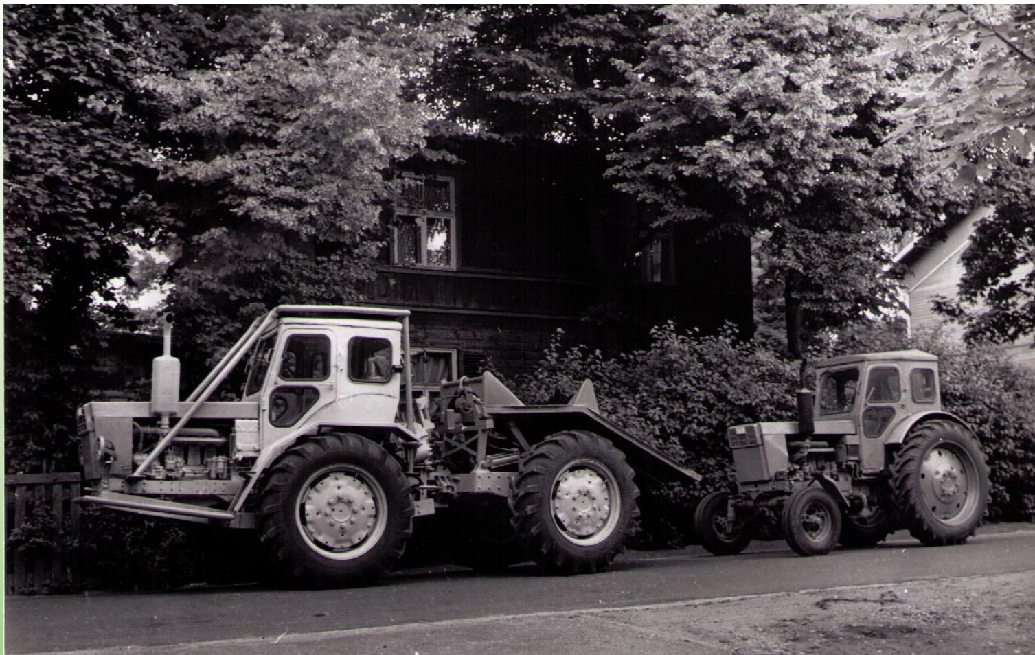
Трактор Т-40АМ и трактор Т-40АМ в агрегате с активным лесохозяйственным полуприцепом АЛП-1.
