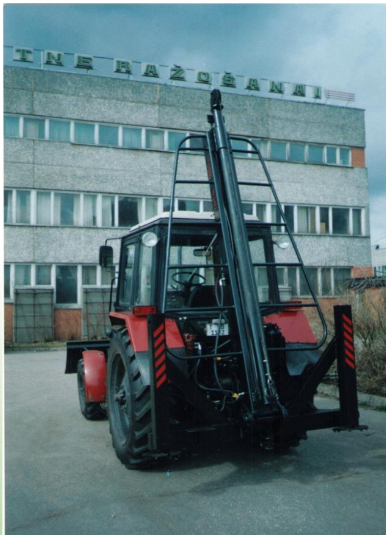
Механизм для извлечения столбов РІМ-4
