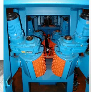
Вальцовый кантователь – точность 10 градусов (2 минуты на стрелке часов)
