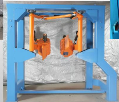
Вальцовый кантователь – точность 10 градусов (2 минуты на стрелке часов)
