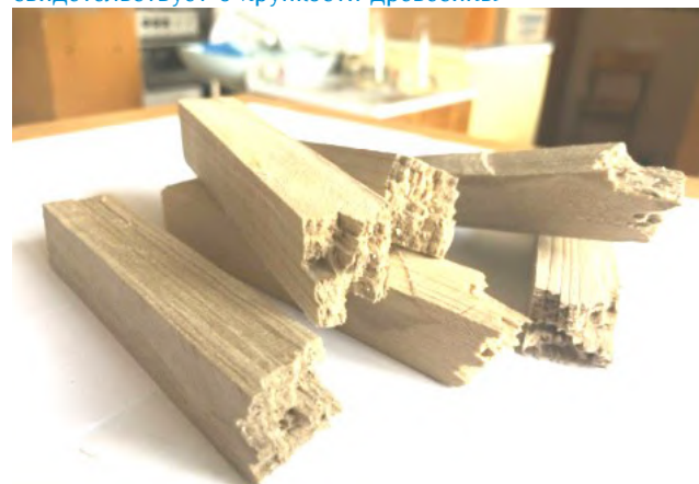
Рисунок 2. Образцы ели после испытания на статический изгиб. Место излома слабозащепистое, что свидетельствует о хрупкости древесины
