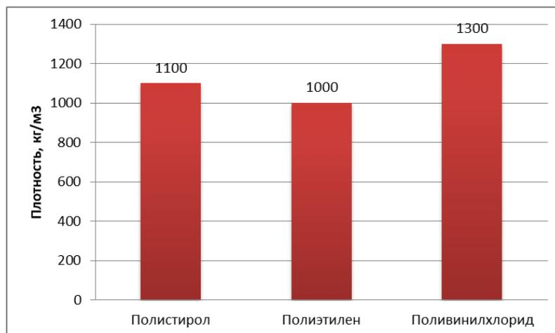
Рисунок 1 – Гистограмма плотности образцов древесно-полимерного материала.
