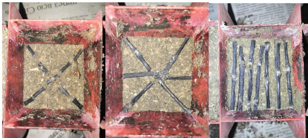
**Рис.2. Послойное выкладывание стекловолоконной сетки**
