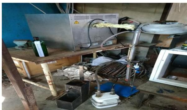
Рис. 1. Внешний вид экспериментальной установки для получения активированного угля
