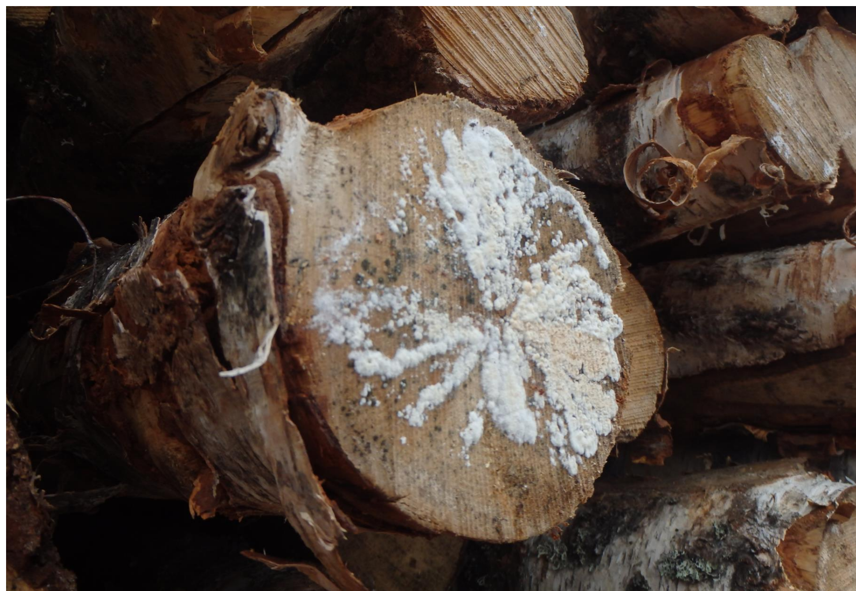
Плесень на торце (относительно недолгое хранение в штабелях, примыкающих торцами друг к другу)
