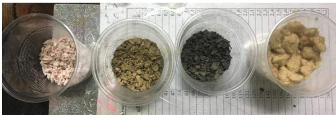
Рисунок. Использованное сырьё для производства композитных плит (слева направо: обувной картон марки СЦМ; обувной картон марки 3-1; кожкартон марки КПЖ; древесное волокно)
