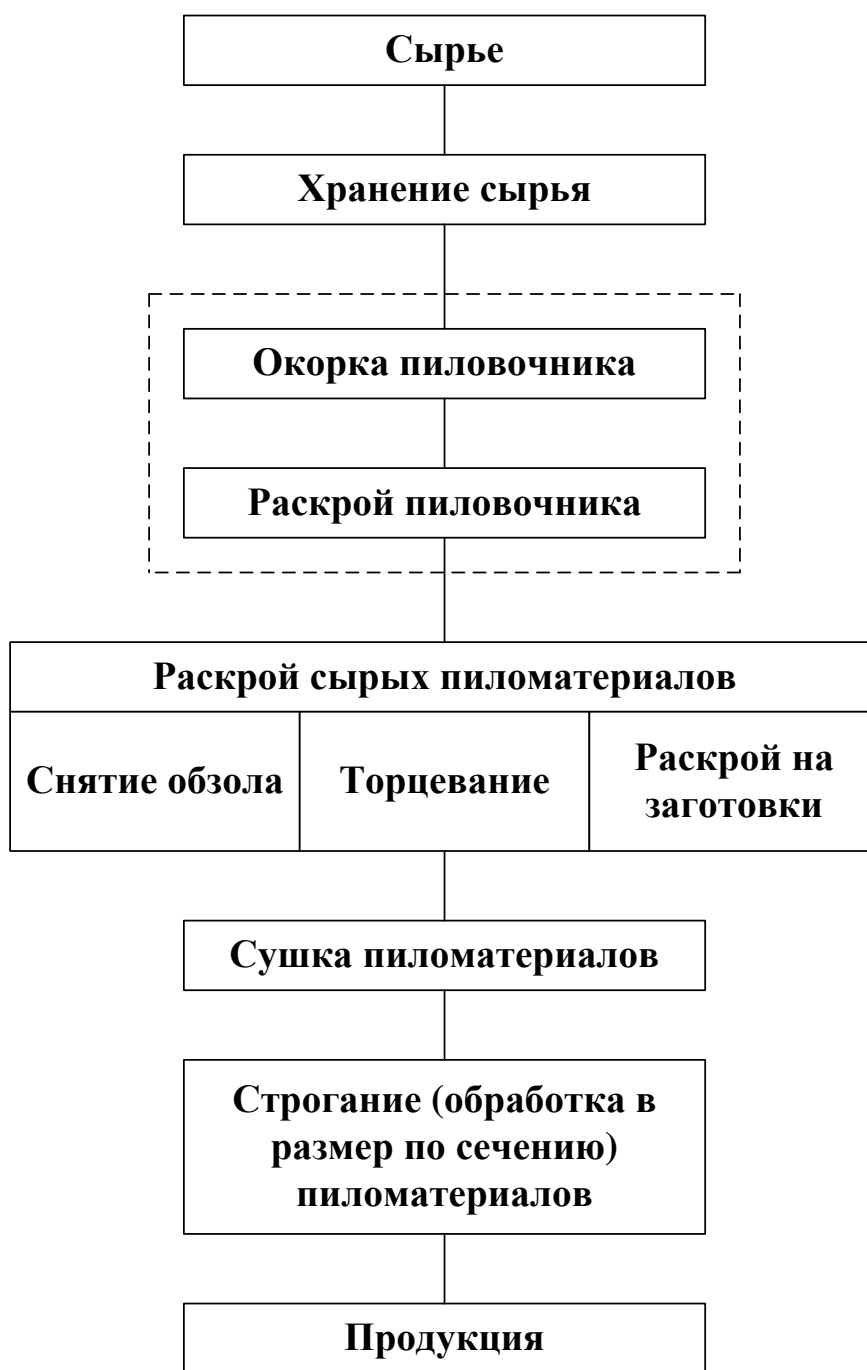
Рис. 5 Структура технологического процесса производства сухих строганых пиломатериалов из цельной древесины
