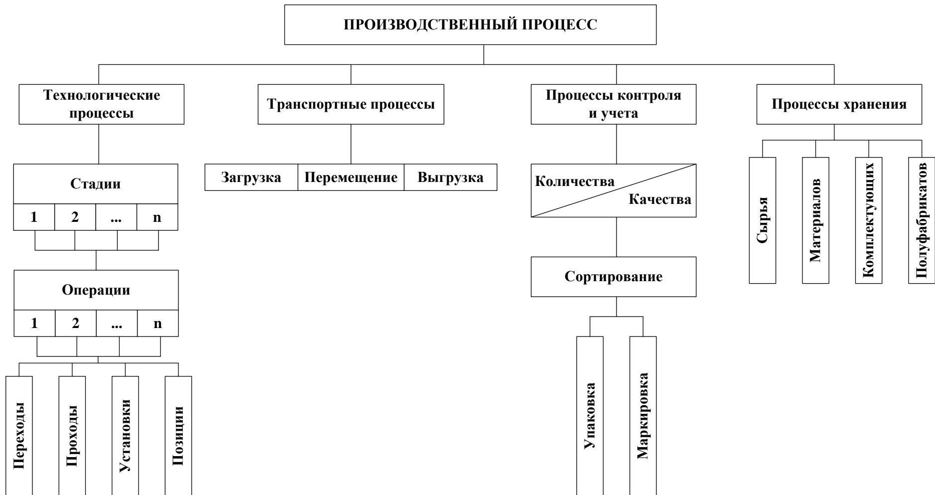
Рис. 4 Структура производственного процесса
