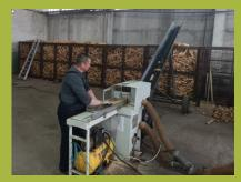
По мимо основного производства фанеры, на комбинате освоен выпуск топливных брикетов типа "RUF", а также сухих берёзовых дров изготовленных из отходов лущения производства.
