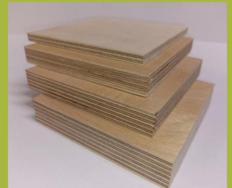
Фанера марки FOF выпускается в соответствии с ТУ 16.21.12-001-12256816-217. Выпускаемая фанера имеет глянцевую поверхность с двух сторон листа, а также может иметь антифрикционное покрытии в виде сетки на одной из сторон листа. В стандартном исполнении фанера имеет покрытие бумагой пропитанной фенолоформальдегидной смолой и имеет темно коричневый цвет. По согласованию с клиентом имеется возможность нанесение меламиновых плёнок различных цветов и оттенков.
